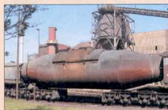
De 'torpedo' brengt het hete staal van de ene productieplaats naar de andere voor verdere verwerking (foto's HKM GmbH, Duisburg)
