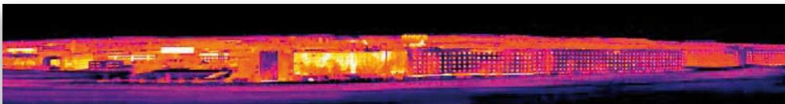
Panoramabeeld gemaakt met een pixelresolutie van 200x150 en een thermische gevoeligheid <math><70\text{mK}</math>.
