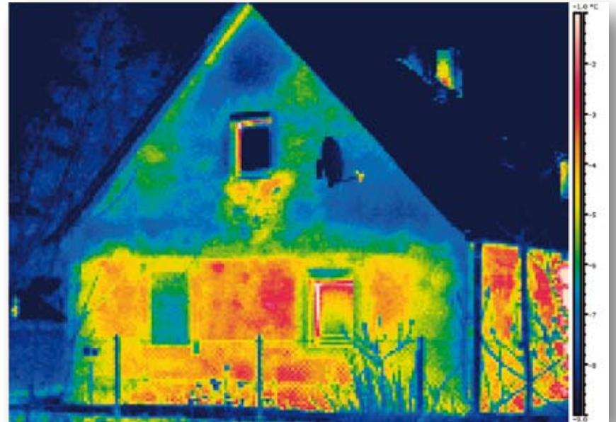
Beeld gemaakt met een pixelresolutie van 200x150 en een thermische gevoeligheid <70\text{mK} .
