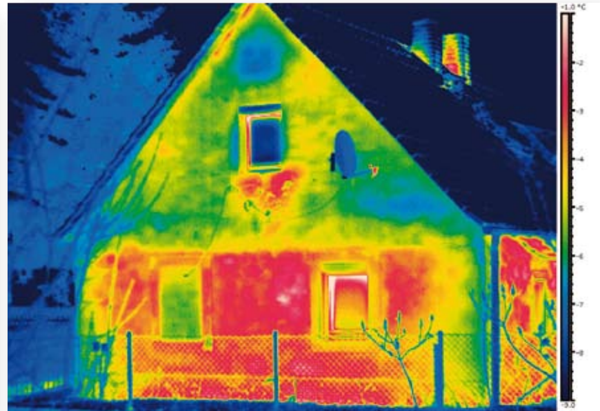
Beeld gemaakt met een pixelresolutie van 640x480 en een thermische gevoeligheid <45\text{mK} . De verhoging van het aantal pixels leidt tot een duidelijker beeld waarin kleine details goed zichtbaar zijn.
